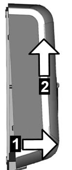
2) Gehäuseabdeckung unten max. 1 cm anheben **1** und danach nach oben wegschieben **2**.
