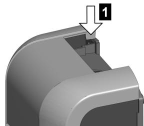
2) Gehäuseabdeckung oben einhängen **1** und unten zuklappen **2**. Die Gehäuseabdeckung muss ohne große Widerstände in die Führungen gleiten. Die Gehäuseabdeckung muss auf allen Seiten korrekt in der Gehäuseführung sitzen.
