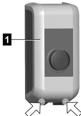
1) Die zwei Schrauben an der Unterseite der Gehäuseabdeckung **1** lösen.
