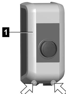
3) Die Gehäuseabdeckung **1** unten mit 2 Schrauben befestigen.
