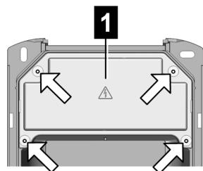
1) Anschlussfeldabdeckung **1** einsetzen und mit 4 Schrauben mit 2 Nm festschrauben. Die Nasen an der Anschlussfeldabdeckung müssen bündig mit dem umschließenden Gehäuse abschließen. Nur so wird das Gerät ordnungsgemäß abgedichtet.
