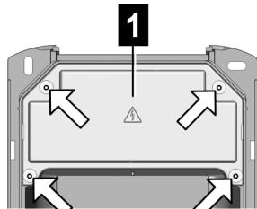
3) Die vier Schrauben der Anschlussfeldabdeckung **1** lösen und die Anschlussfeldabdeckung nach oben wegnehmen.
